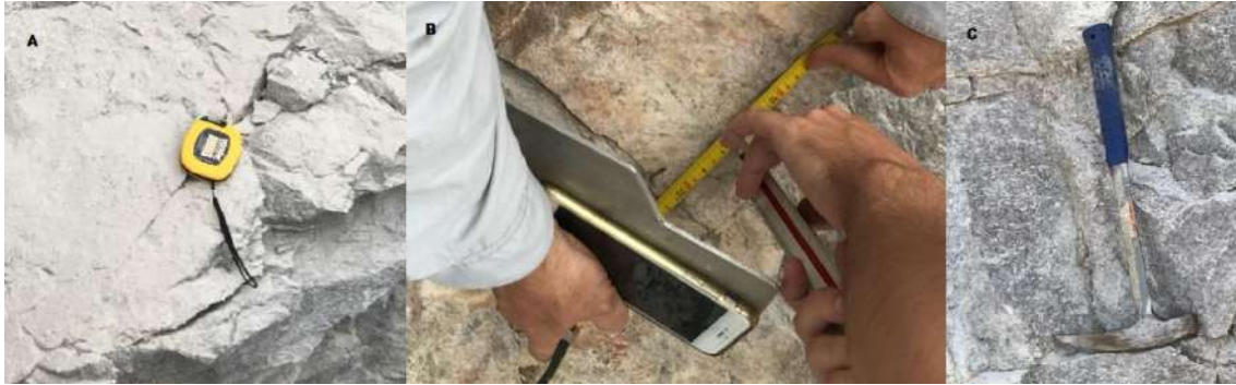
Figura 7 - Equipamentos utilizados: trena (A); smartphone, chapa e escalimetro (B) e martelo de geólogo (C).
