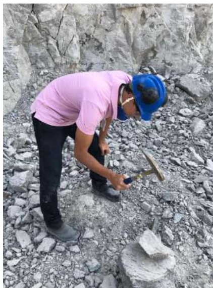
Figura 8 - Teste do martelo de geólogo.
